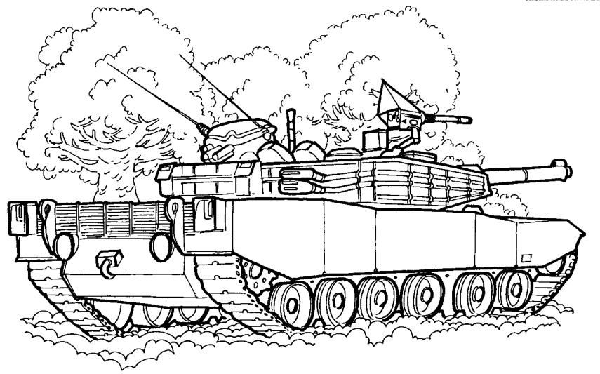
Основной танк **ТИП 88** (Южная Корея). Масса — 51 т. Скорость — 65 км/ч. Экипаж — 4 чел. Вооружение: 105 мм пушка, 12,7 мм пулемёт, два 7,68 мм пулемёта.
