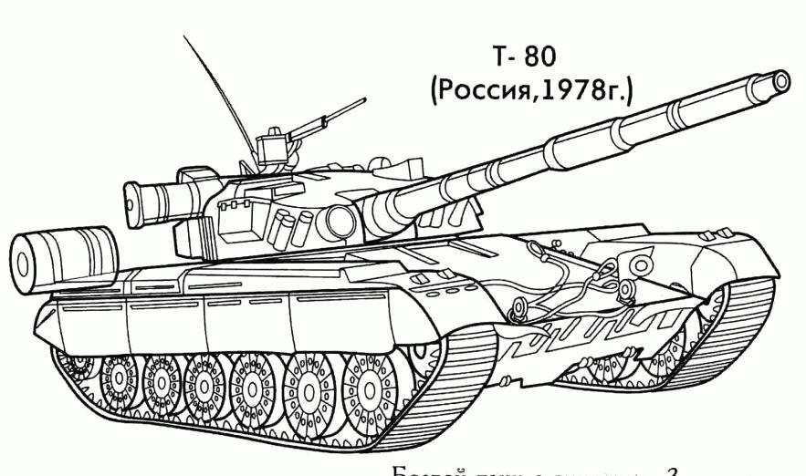
Боевой танк с экипажем 3 человека. 125мм пушка 2A 46. 12,7мм пулемёт NSVT Fla-MG
